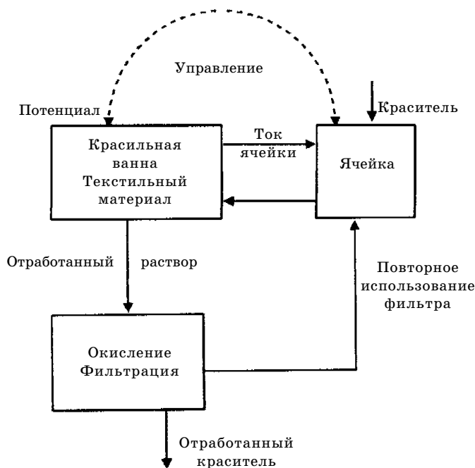
Рис.3. Схема потоков в красильной машине, включая циркуляцию в ячейке и генерирование медиатора
